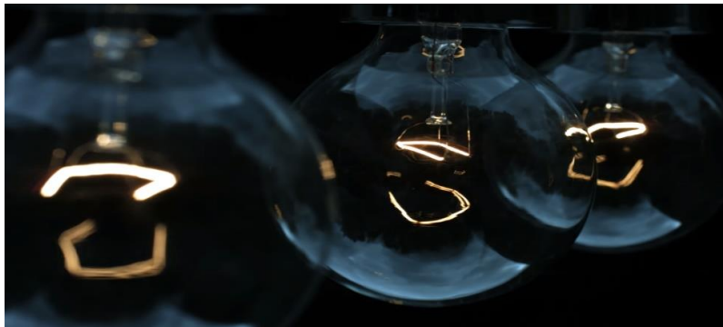
Thomas Edison uso fibras de carbono como filamentos en sus primeras bombillas Fuente: Real Engineering
