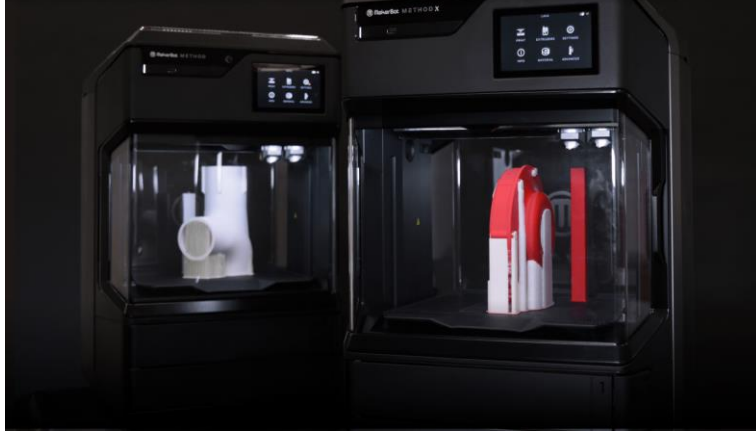
Impresión 3D FDM en proceso con material MakerBot SR-30
